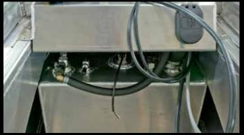
ALUMINUM 46 GALLON FUEL TANK INTEGRATED INTO THE CENTER PONTOON TRANSOM.
